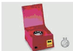
Слика 10. Опрема која е неопходна за определување на мастите во млекото: а) бутирометар со чеп, б) Gerber-ова центрифуга
